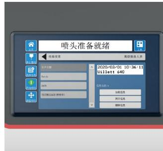
可视化作业选择和布局预览功能帮助操作员喷印正确的编码。
